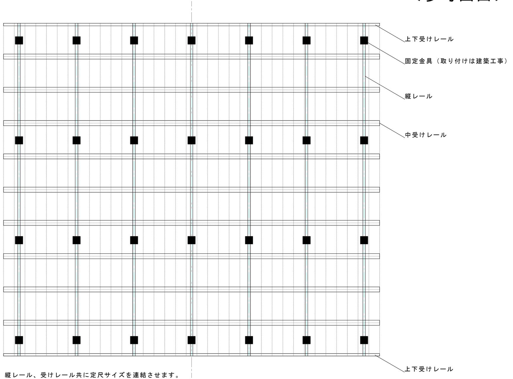
縦レール、受けレール共に定尺サイズを連結させます。
